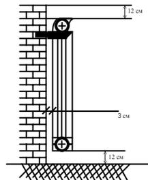
4.11. а) В период между отопительными сезонами, а также в случае необходимости, рекомендуется отключить радиатор от системы отопления. Поскольку отопительная система должна быть заполнена теплоносителем в течение всего периода эксплуатации, требуется проводить отключение в следующей последовательности: сначала отключить клапан обратной подводки, затем клапан подающей подводки, после чего открыть клапан выпуска воздуха;
