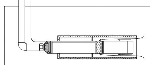
Для прокачки скважины может потребоваться некоторое время. Выключение насоса в этот момент чревато засорением гидравлической части насоса песком.
