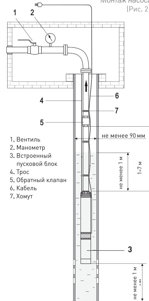
Монтаж насоса в охлаждающем кожухе (Рис. 3)
