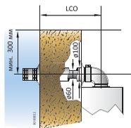
При установке трубы LCO = 3м, удалить диафрагму (металлическое кольцо) на выходе вентилятора.
