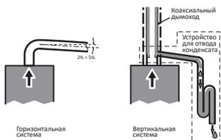
**Размещение терминалов в зависимости от их тепловой производительности****Забор воздуха и выброс продуктов сгорания с применением коаксиальных труб**
