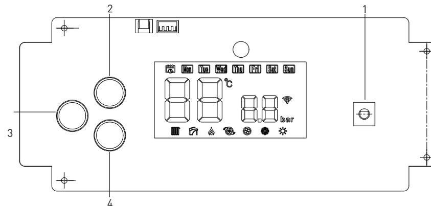
1. Ручка регулировки температуры отопления / ГВС
