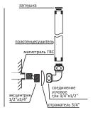
Заглушки входят в комплектацию полотенцесушителя и уже установлены производителем на заводе. Во избежание протечек заглушек не рекомендуется выкручивать и менять их при установке. Заглушка с воздухоотодчиком (кран Маевского) и заглушка располагаются в верхней части полотенцесушителя.
