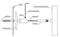
\*Диаметр шляпы самореза не больше 7,5 мм
